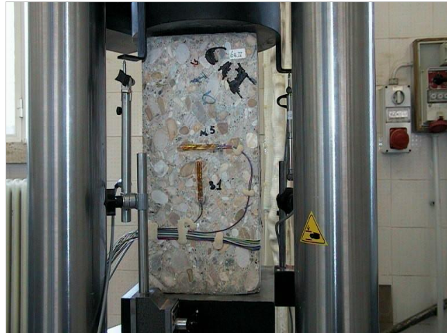
Figura 2.19 Campione di prova sottoposto a compressione
