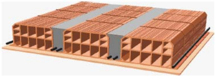
Figura 10.7 – Solaio in laterocemento gettato in opera: assonometria
