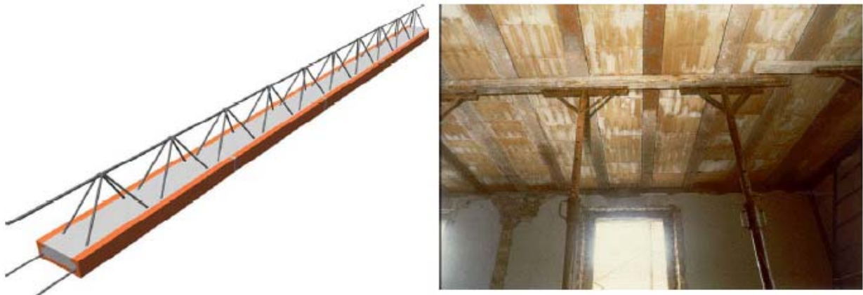
Figura 10.9 – Solai in c.a. con travetti intralacciati
