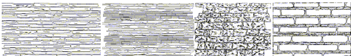
Fig. 5.6 - Esempi di murature in pietra lastriforme e pseudoregolare senza e con ricorsi di mattoni
