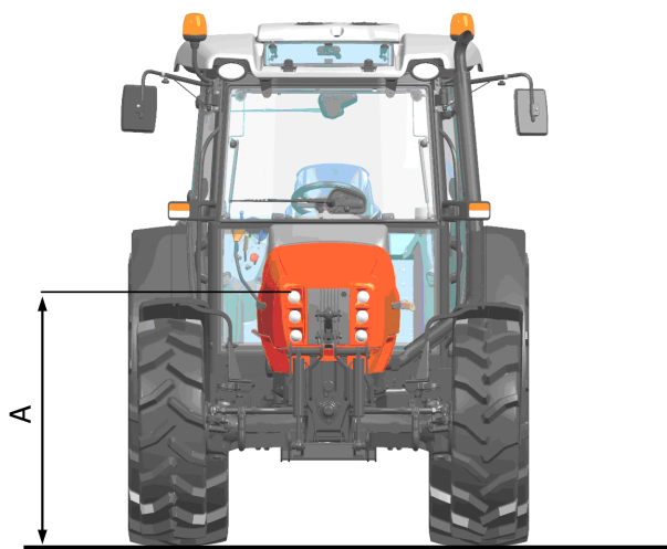
Fig. 14. Posizione in altezza dei proiettori anabbaglianti
