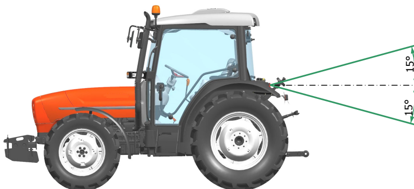
Fig. 25. Angoli verticali delle luci di arresto
