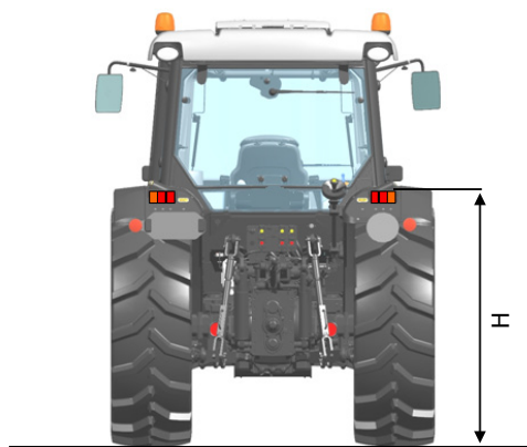
Fig. 23. Posizione in altezza delle luci di arresto
