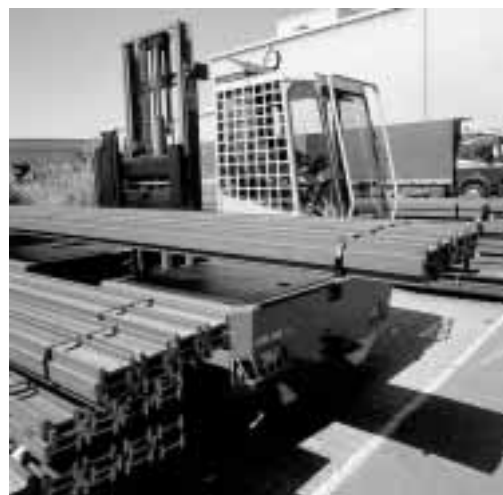
Figura 3: i profilati in acciaio devono essere tenuti assieme da fascette metalliche per evitare che possano cadere lateralmente dalle forche.
