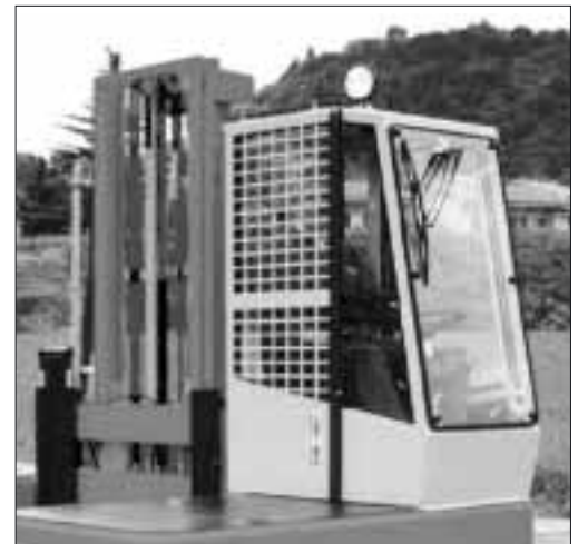
Figura 1: cabina del conducente con griglia di protezione sul lato del carico.
