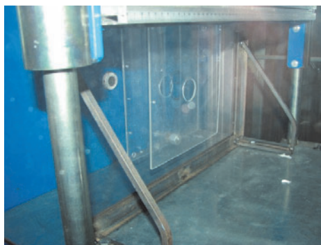
Figura 9. Setti di plexiglas per ridurre l'effetto dell'aria sparata con il proiettile
