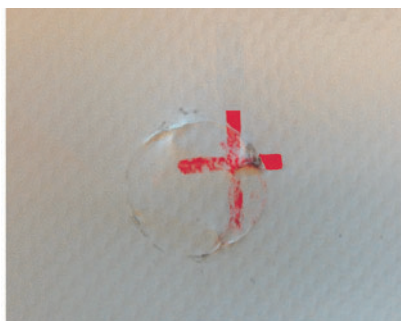
Figura 56. Impronta del proiettile nel punto d'impatto
