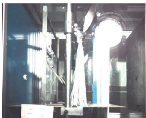
Figura 39. Prova positiva Assemblaggio Poliestere 20 strati h=400 mm prima (A) e dopo l'impatto (B)
