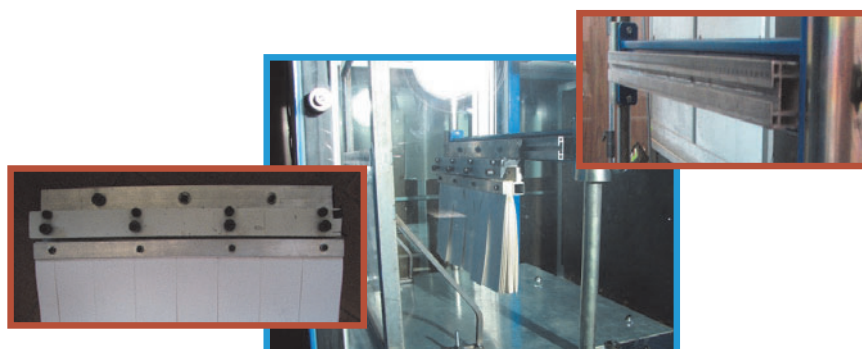
Figura 21. Particolari del supporto nella camera di prova
