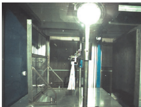
Figura 43. Prove positive Assemblaggio in poliestere h= 200 mm prima (A) e dopo l'impatto (B)
