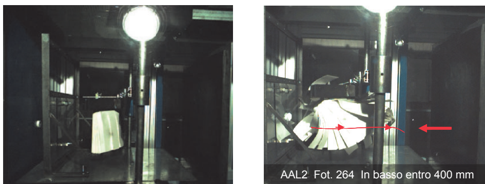
Figura 52. Prova positiva Assemblaggio AAL2 Aramidica h=200 mm prima (A) e dopo l'impatto (B)
