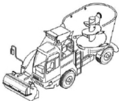
a) Carro desilatore miscelatore semovente verticale
