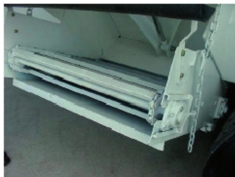
Figura21. Esempi di protezione applicata al nastro trasportatore
