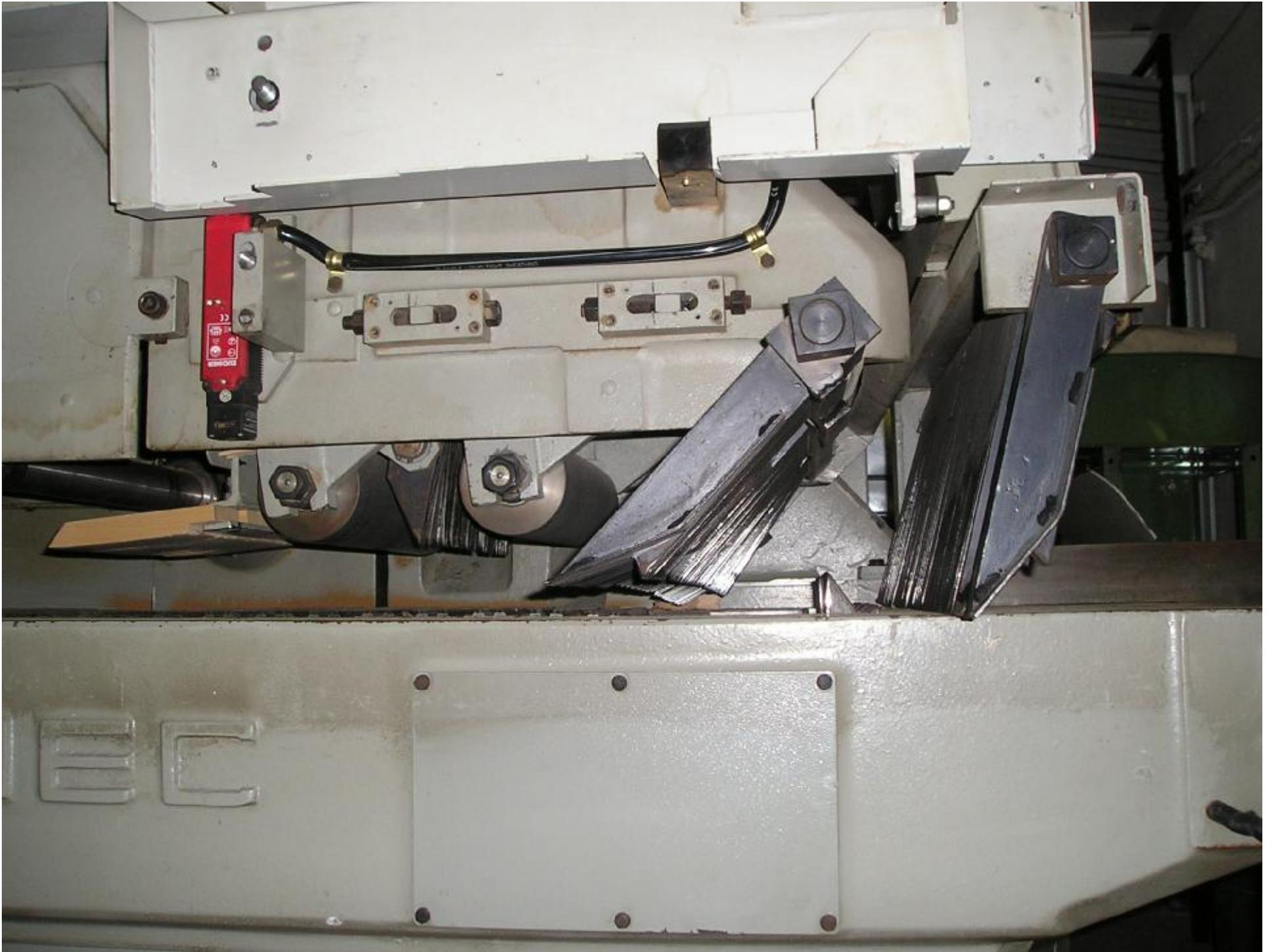
Per minimizzare il pericolo di fuoriuscita di schegge e sfridi di lavorazione che potrebbero incunearsi / passare a lato o attraverso la cortina di martelletti, eliminare ogni fessura sul lato alimentazione e “impaccare” adeguatamente i martelletti.
