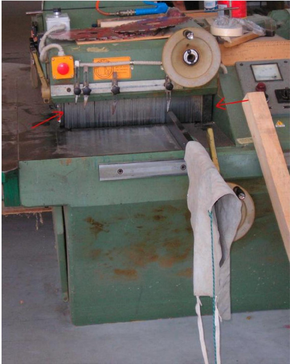
La Norma UNI EN 1870-4 / 2003 (Seghe circolari multilama per il taglio longitudinale con carico e/o scarico manuale) non definisce il grado di “impaccamento” cui sottoporre le file di martelletti paraschegge per far sì che gli stessi, pur mantenendosi mobili, siano il più possibile accostati e paralleli tra loro (in pratica quale sia la massima distanza ammissibile tra le punte dei martelletti a livello del banco).
