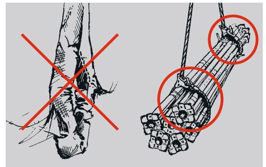
I carichi da trasportare con il bagger vanno imbracati correttamente.
