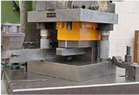
Punto di schiacciamento tra vite di bloccaggio e slittone
