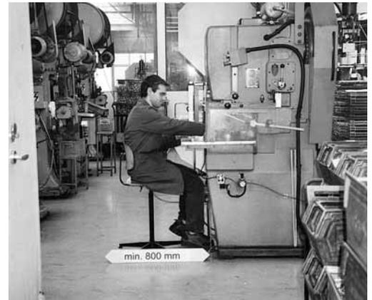
Figura 1: prevedere uno spazio libero di almeno 800 mm per consentire all'operatore una sufficiente libertà di movimento.
