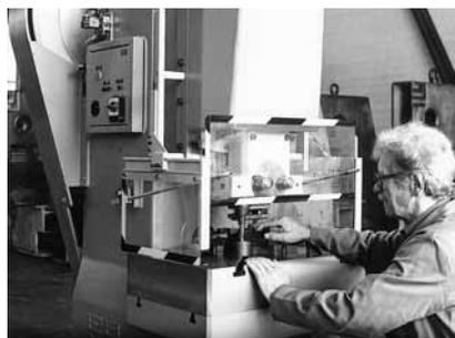
Figura 4: alimentazione del pezzo da lavorare a una pressa provvista di dispositivi protetti dita e schermo di protezione. L'impiego di questo dispositivo di protezione è vietato a partire dall'1.1.2012.
