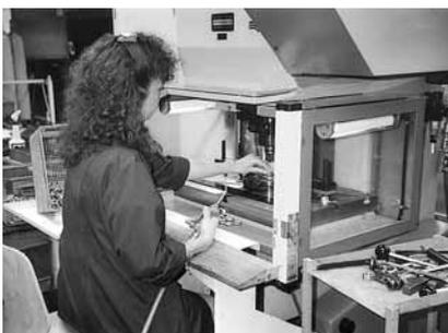
Figura 3: alimentazione manuale del pezzo da lavorare a una pressa dotata di dispositivo di protezione immateriale.
