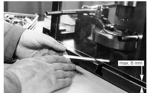
impostazione del dispositivo proteggi dita con schermo di protezione.
