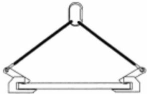
**Morse per piastre:** dispositivo non motorizzato utilizzato per movimentare piastre di acciaio mediante il loro serraggio tra mascelle.
