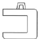
**Gancio a C: dispositivo a** forma di 'C' utilizzato per il sollevamento di carichi cavi come ad es. bobine, tubi, ecc.
