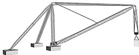
**Gru Derrick:** gru girevole con un braccio incernierato nella parte inferiore di un montante verticale che è supportato in alto e nella parte inferiore.
