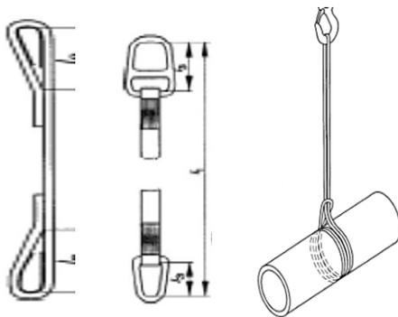
**Braca di nastro tessuto piatto:** braca flessibile consistente di un componente a nastro cucito, con o senza accessori (vedere prospetto 2) per il fissaggio di carichi al gancio di una gru o di un'altra apparecchiatura di sollevamento [EN 1492-1].
