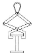
**Pinza:** dispositivo utilizzato per movimentare carichi mediante il serraggio su un parte specifica del carico - noto anche come pinza.
