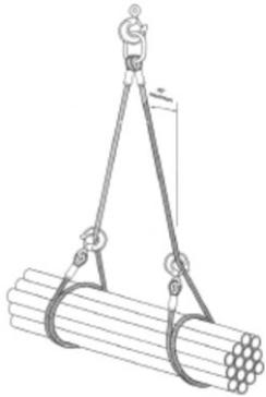
**Brache a fune di acciaio per usi generali nel sollevamento:** gruppo di componenti che include uno o più bracci singoli o una braca ad anello continuo destinata a una varietà di operazioni di sollevamento e non progettata per un'applicazione di sollevamento specifica [EN 13414-1].
