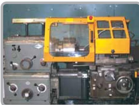
Nella lavorazione da "barra" tutta la parte sporgente di questa deve essere completamente racchiusa all'interno di un riparo fisso (vedi "Ripari fissi" in 2.2.3.2) o mobile interbloccato (vedi "Ripari mobili" in 2.2.3.2) in grado di impedire il contatto con la barra in rotazione e di contenere eventuali deformazioni della barra stessa.
