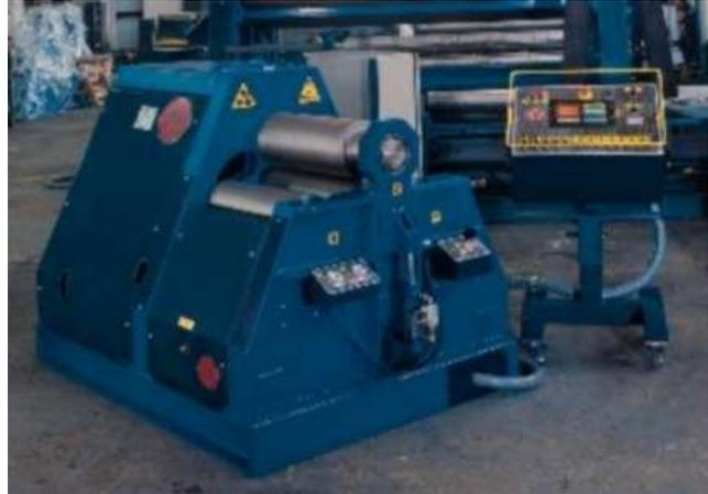
**Le calandre dotate del solo dispositivo di sicurezza a comando a due mani, ai fini della sicurezza, non possono essere dotate anche del comando a pedale alternativo al comando a due mani, in quanto, in questo caso, l'operatore usando il pedale per il comando, non sarebbe protetto da nessun dispositivo di sicurezza.**
