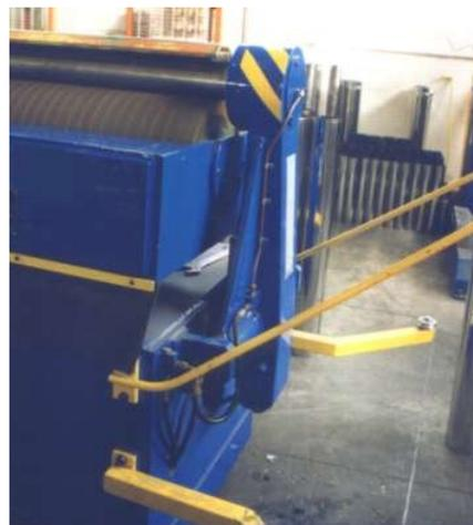
Se per necessità di lavorazione non fosse possibile installare il riparo fisso frontale ai cilindri lavoratori, la calandra deve essere dotata di un dispositivo di sicurezza (funne di guardia o barra sensibile) interbloccato e contornante la zona pericolosa (art. 132 DPR 547/55).
