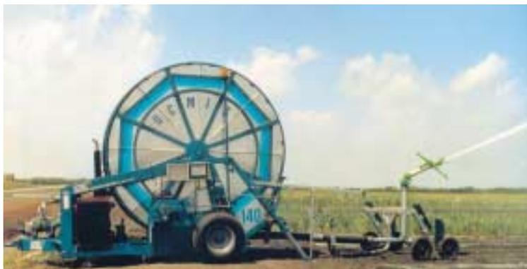
Fig. 1 - Irrigatori semoventi ad ala avvolgibile – irrigatori a naspo.
