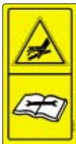
Fig. 8 - Nell'inserimento dei tubi idraulici ed in caso di interventi volti ad identificare eventuali perdite con l'impianto in pressione, devono essere utilizzati adeguati dispositivi di protezione individuale quali guanti, schermi, occhiali.
