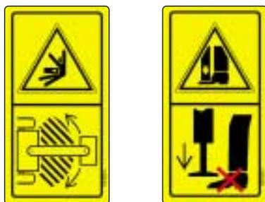
Fig. 5 - Esempio di pittogrammi richiamanti l'attenzione sui rischi connessi all'accoppiamento ed al disaccoppiamento della macchina alla trattrice.
