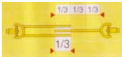
Fig. 9 - L'albero cardanico deve essere fissato correttamente alla p.d.p., rispettando il verso di collegamento indicato e fissando i dispositivi di ritegno (le catenelle).
