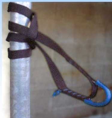
ANCORAGGIO A FETTUCCIA (come da progetto)
