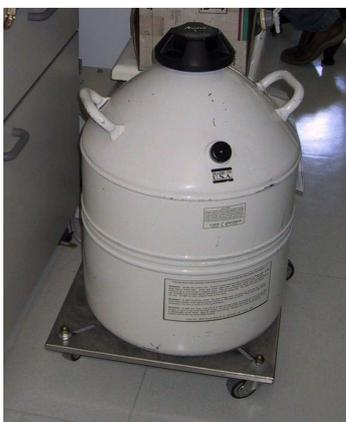
In queste condizioni viene ridotto al minimo lo scambio di calore per conduzione fra il contenitore interno e quello esterno, questo accorgimento consente di conservare i gas liquefatti a temperature molto basse in locali a temperatura ambiente.
