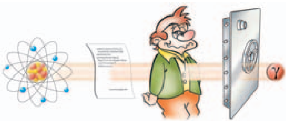
Figura 1.3. Nuclei di elementi radioattivi diversi possono decadere secondo tre possibili modalità: emettendo cioè radiazioni alfa, beta o gamma. Ciascun tipo di radiazione ha capacità differente di attraversare la materia, compresi i tessuti del corpo.
