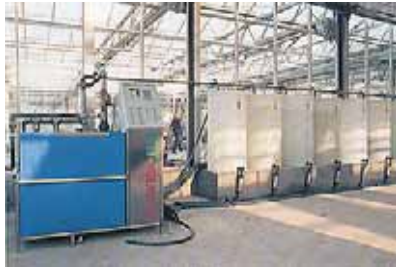
Impianto per fertirrigazione
