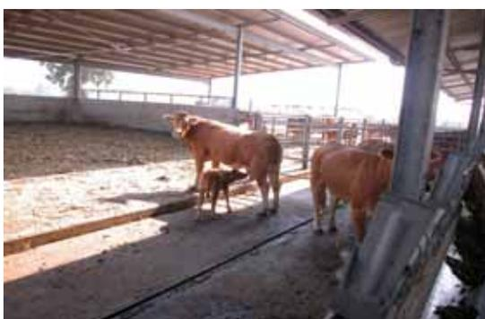
**Figura 3 - Ricovero per linea vacca-vitello con lettiera e raschiatore nella zona di alimentazione**
