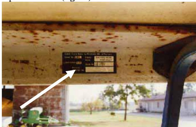
**Fig. 20** - Sul telaio o sulla cabina devono essere riportati gli estremi di omologazione, punzonati o su una targhetta rivettata o incollata, collocata in un punto visibile.
