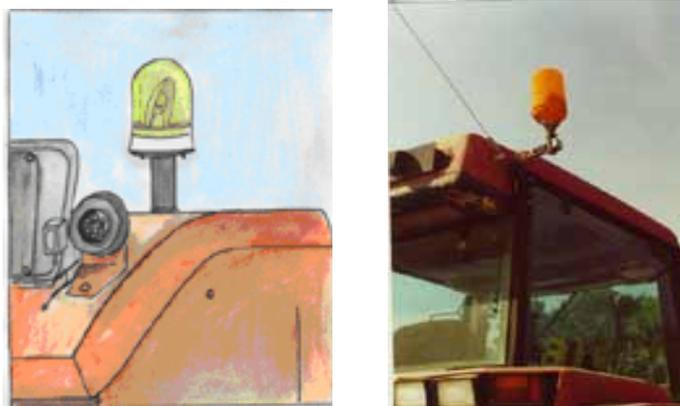
**Fig. 2 – Il lampeggiante giallo rende più visibile la movimentazione del treno trattore-operatrice.**
