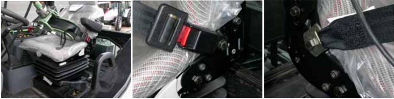
**Fig. 7 - Per una fattiva protezione del conducente in caso di rovesciamento del trattore, è necessario che il sedile sia dotato di cintura di sicurezza addominale (a sinistra, in prova), che sia fissata alla struttura del sedile (al centro e a destra), oppure a parti strutturali del trattore.**
