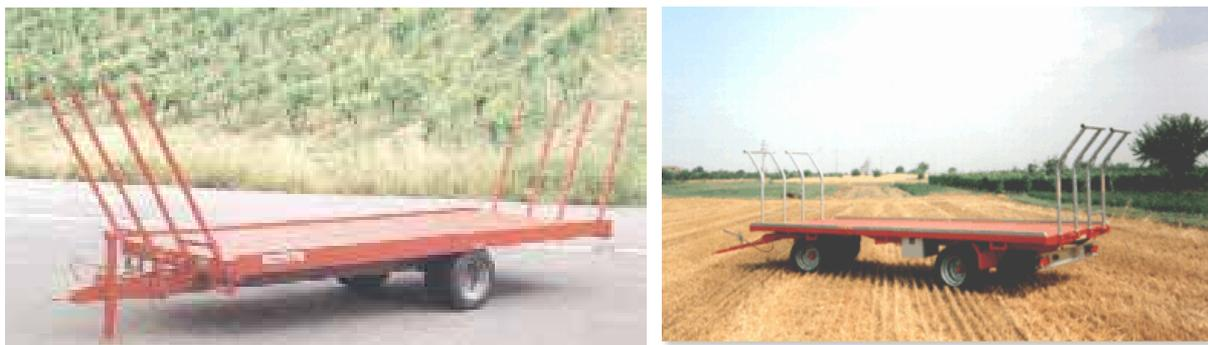
**Fig. 6 - Con i rimorchi normali, dotati o meno di sponde anteriori, posteriori e laterali, oltre ad un attento posizionamento, bisogna sempre adottare idonei sistemi di legatura del carico.**
