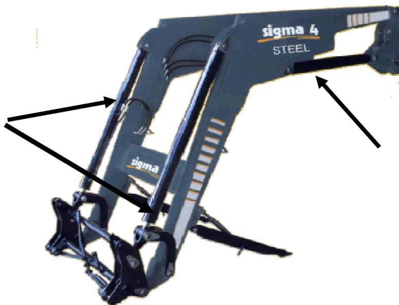
Fig. 4 - L'azionamento del caricatore è idraulico, tramite appositi cilindri, alimentati dall'impianto omonimo a corredo del trattore, e comandati tramite un distributore a leve, disposto al posto di guida per un'agevole operatività da parte del conducente.
