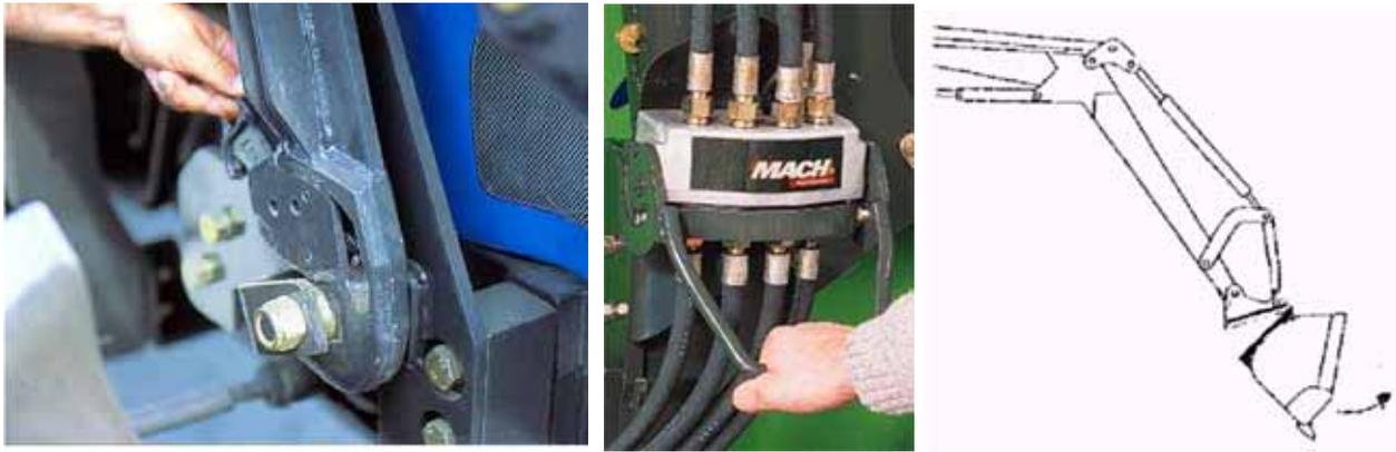
**Fig. 5 – Dopo aver effettuato i collegamenti meccanico (a sinistra) e idraulico (al centro), si verifichi con limitati spostamenti a velocità ridotta (a destra) il corretto assemblaggio del tutto.**
