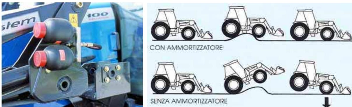
**Fig. 13 - Gli assorbitori di shock ad azoto sono in grado di migliorare significativamente l'operatività, specie in caso di marcia veloce e su superfici irregolari.**
