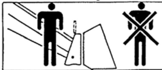
**Fig. 6 – Durante le operazioni preliminari di aggancio, se è necessaria la presenza di un addetto a terra per aiutare il centraggio dell'attrezzatura, è molto importante che l'individuo in questione assuma una posizione (laterale) ben visibile dal guidatore, ad una distanza tale da non poter essere intercettato dagli organi in movimento.**
