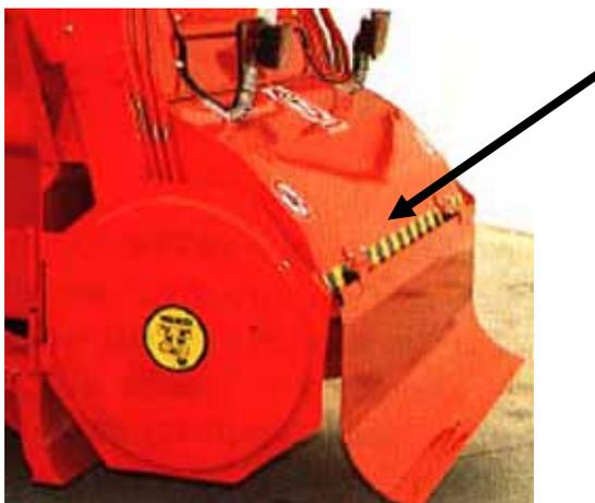
**Fig. 4 - Il carter coprifresa è sollevato automaticamente, sia frontalmente che lateralmente, tramite sensori solo quando l'apparato entra in contatto con il fronte di prodotto da caricare.**
