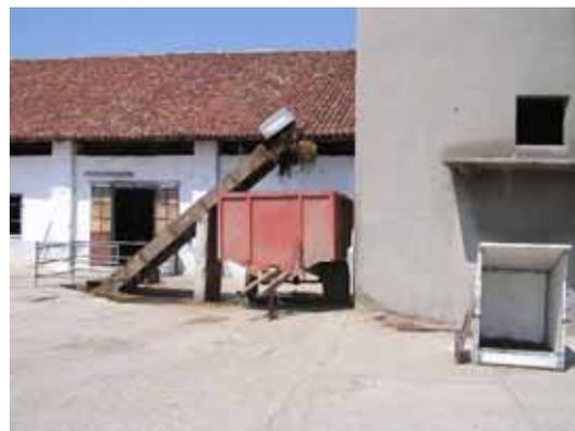
Figura 30 – Allontanamento dello stallatico con nastro elevatore nelle stalle a stabulazione fissa.
