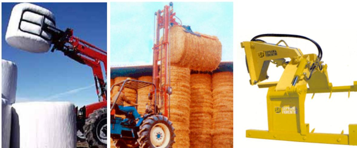
**Fig. 3 -** Per il sollevamento delle balle, si sono diffusi recentemente interessanti sistemi a pinze, sia semplici (che salvaguardano l'integrità del prodotto imballato, a sinistra), sia dentate (al centro e a destra) che permettono una presa sicura anche per situazioni impreviste.
