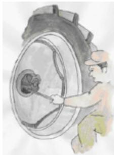
**Fig. 9 - Tutti i bulloni di fissaggio della ruota alla flangia del semiassie devono essere montati e risultare correttamente avvitati.**
