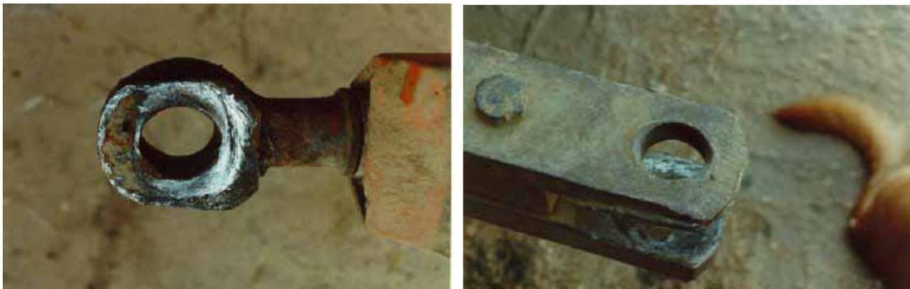
**Fig. 13 – Un eccessivo gioco del perno nell'occhione porta ad una rapida usura di quest'ultimo e a possibili rotture.**
