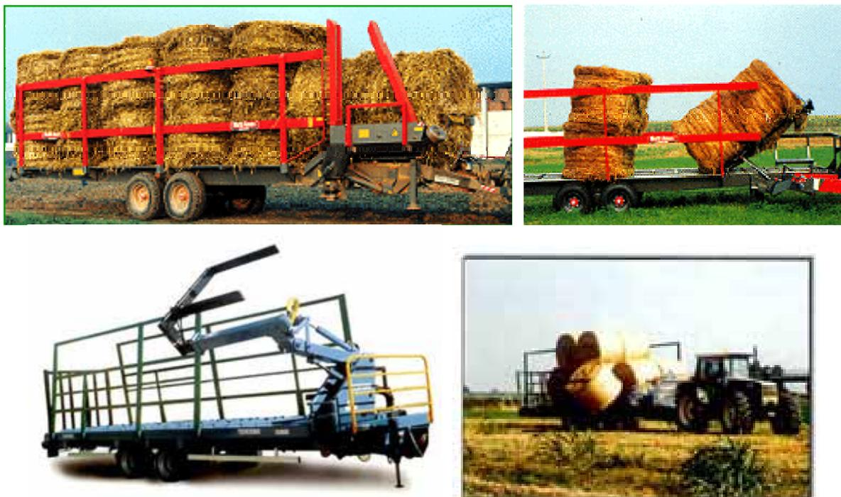
**Fig. 5** - I rimorchi espressamente dedicati alla movimentazione delle balle possono avere sistemi che rendono automatiche le operazioni di carico/scarico (sia con rotoballe in colonna, *sopra*, che in rotolo, *sotto*); facilitano in tal modo il lavoro dell'operatore e soprattutto risolvono alla radice eventuali problemi di sicurezza.
