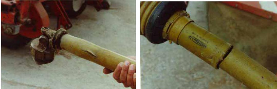
**Fig. 5 - I tubi telescopici di protezione dell'albero cardanico devono essere integri, privi di tagli, deformazioni, slabbrature, ammaccature, ecc.**
