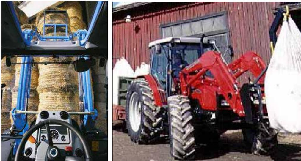
**Fig. 4** - Dal punto di vista della sicurezza di manovra, i sollevatori anteriori sono da preferirsi rispetto a quelli posteriori, perché permettono al conducente una migliore visibilità.
