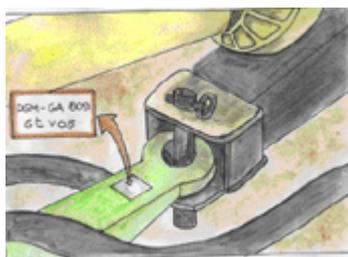
**Fig. 12 - L'occhione che correda l'operatrice trainata deve essere sottoposto a prove di omologazione, per cui deve riportare sulla propria superficie gli estremi relativi, punzonati o in rilievo.**
