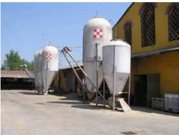
**Figura 19 – Sili verticali in vetroresina per mangime concentrato.**
