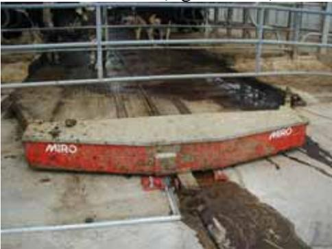
**Figura 8 – Raschiatore per asportazione delle deiezioni.**
