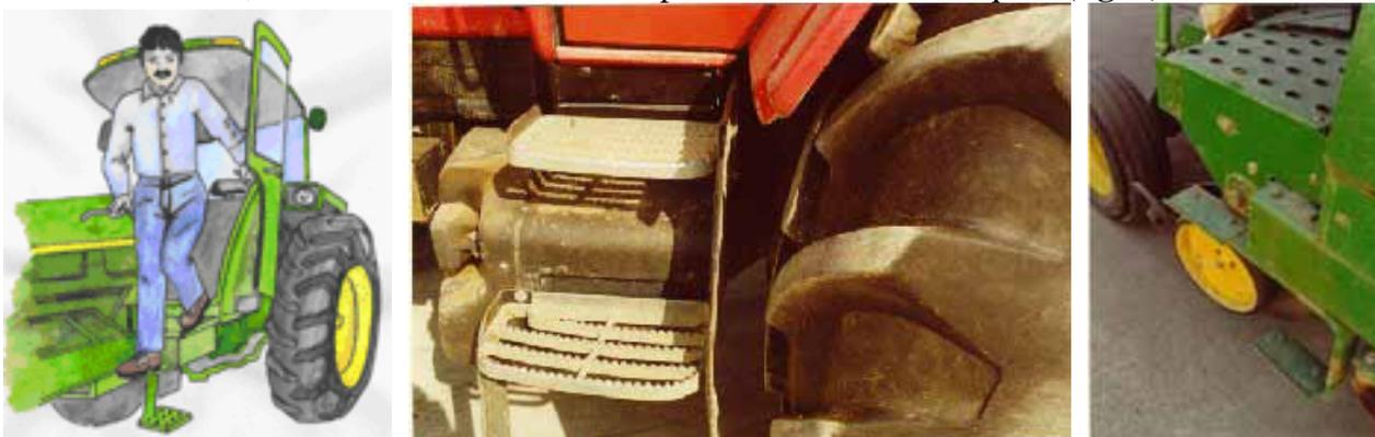
**Fig. 5 - I gradini devono essere costituiti da materiale antiscivolo, con una conformazione che permetta lo scolo dei liquidi.**
