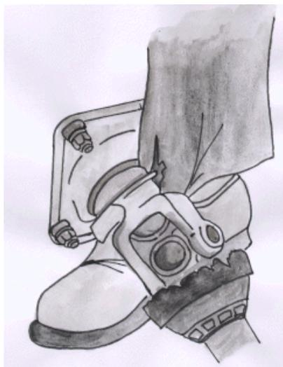
**Fig. 1 –Intrappolamento nell'albero cardanico di lembi di indumenti**
