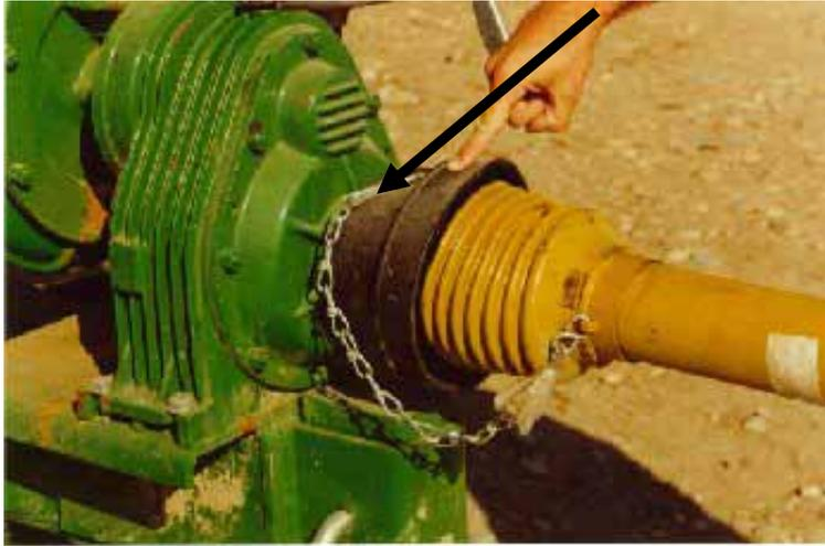
**Fig. 7 - Occorre sempre fissare le apposite catenelle che evitano la rotazione della protezione a parti fisse del trattore e della macchina operatrice.**
