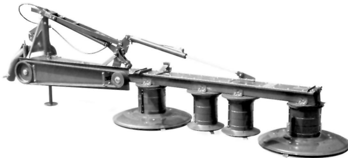
Falciatrice rotativa ad asse verticale a tamburi (N.B.: macchina priva di telo di protezione)
