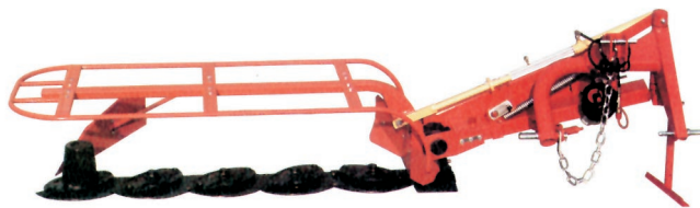
Falciatrice rotativa ad asse verticale a dischi (N.B.: macchina priva di telo di protezione)
