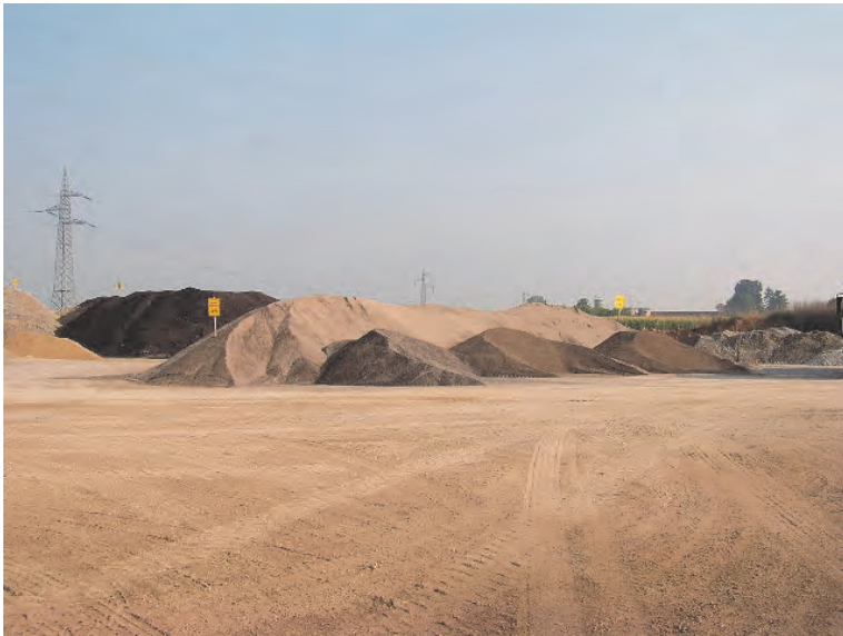
Figura 14 - Stoccaggio inerti nello stabilimento di produzione
