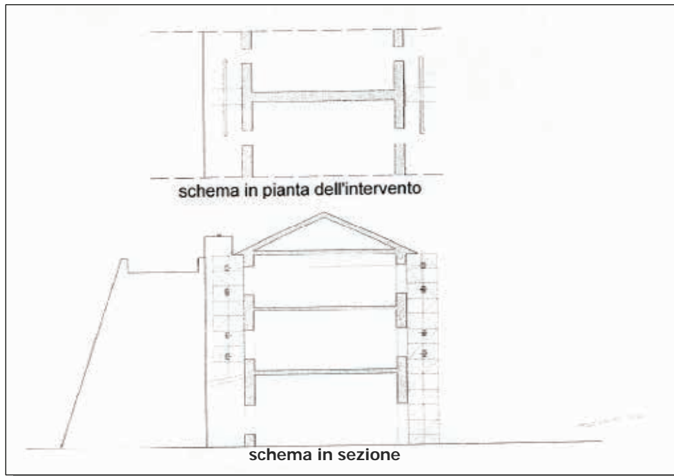
Posizionamento del graticcio realizzato in tubo quadro e posizionamento delle travi HEA 260 di ancoraggio ai tiranti in cavo di acciaio \phi 20 (Archivio NCP).
