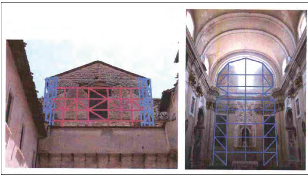
Configurazione geometrica del graticcio ipotizzato (Archivio NCP).
