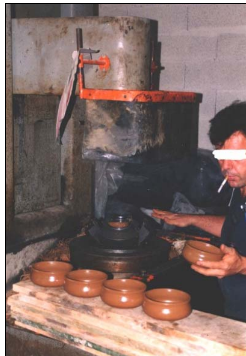
Foto 24: operazione di stampaggio con una vecchia pressa
