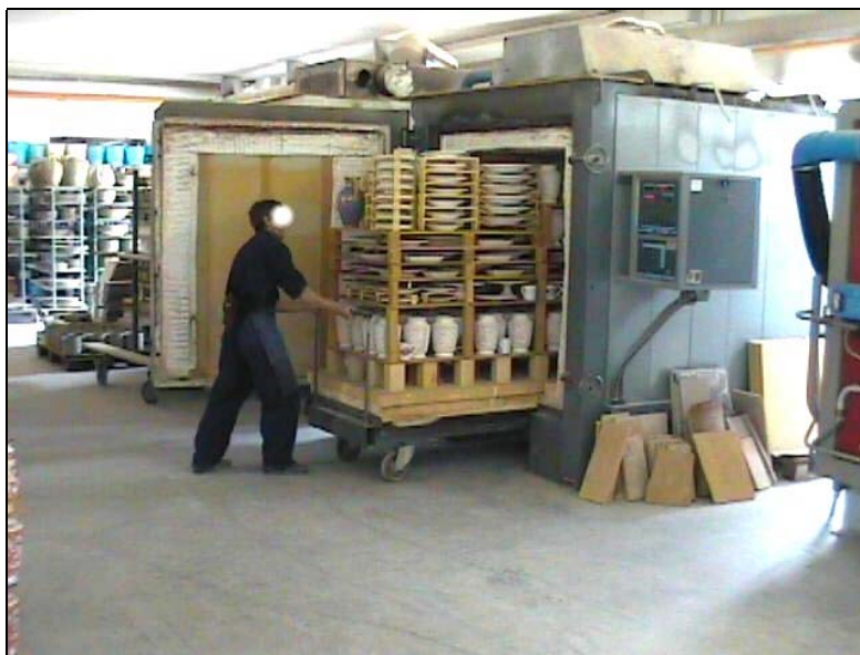
Foto 30: estrazione del carrello dal forno dopo la cottura. La coibentazione del forno, in questo caso, prevede "a vista" in parte laterizi refrattari, in parte materassini di FCR (bianchi nella foto)
