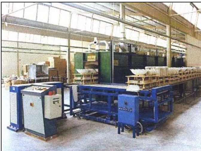
Foto 11: forno a tunnel; il materiale da cuocere è montato su caselle che si muovono su piastre striscianti
