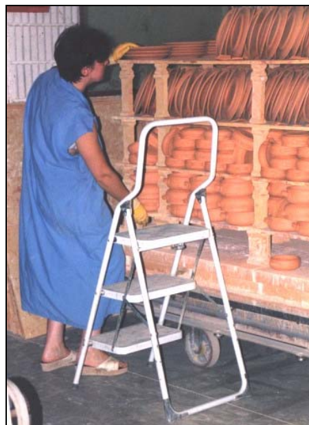
Foto 29: carico del carrello del forno: uso della scala, uso di calzature inadatte
