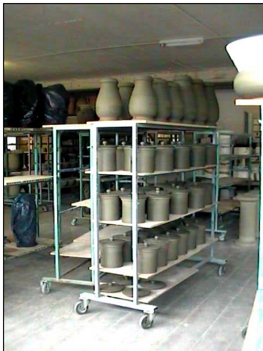
Foto 27: carrello movimentabile a spinta, per l'essiccazione e il trasporto dei manufatti
