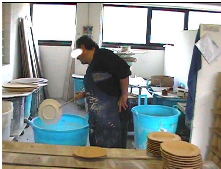
Foto 13: smaltatura per immersione del biscotto, con l'impiego di pinze
