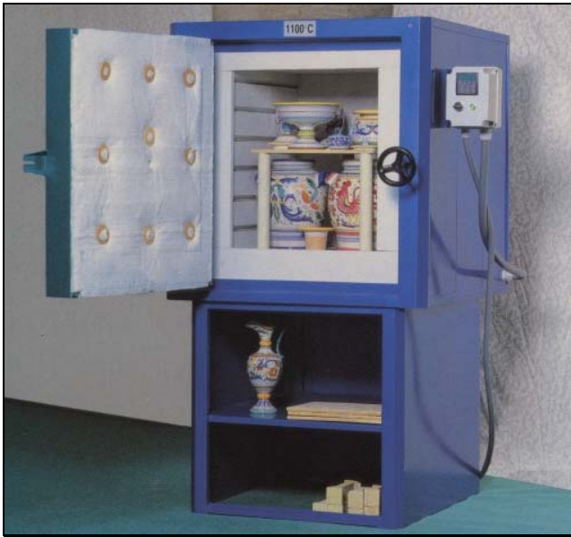
Foto 9: forno di piccolo volume, a gas metano, coibentato con fibre ceramiche refrattarie
