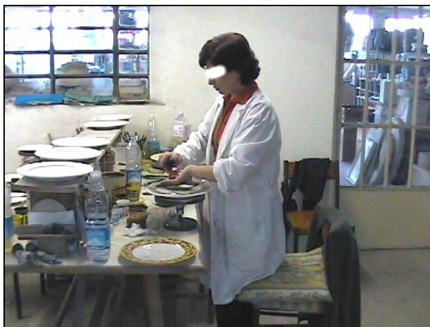
Foto 15: il disegno-base si ottiene spolverando la carbonella sull'oggetto da decorare
