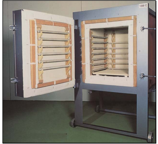
Foto 10: forno elettrico da 250 litri, coibentato con fibre ceramiche refrattarie
