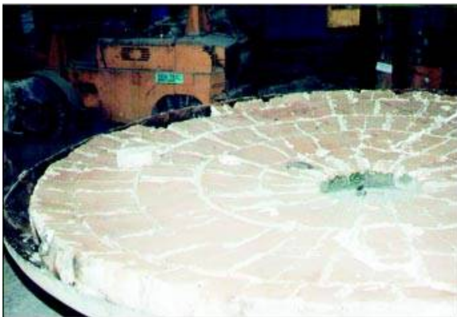
Figure 6 e 7: Lavori di rimozione della fibra usurata dal coperchio di una siviera
