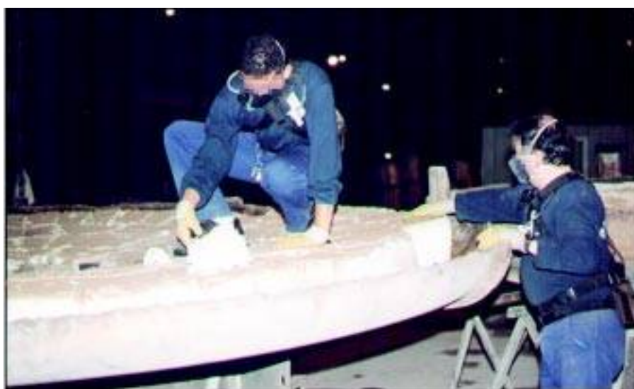
Figure 6 e 7: Lavori di rimozione della fibra usurata dal coperchio di una siviera
