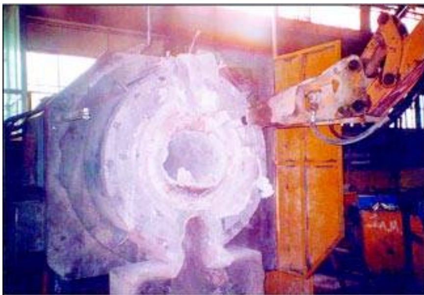
Figure 11 e 12: Demolizione di un forno fusorio in fonderia. La fibra è confinata tra la pigiata refrattaria e il cemento refrattario
