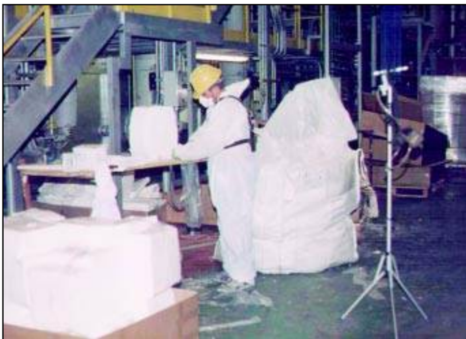
Figure 9: Rifinitura dei blocchi di fibra per la coibentazione di un forno
