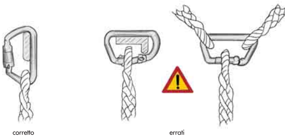
Fig. 42 - Carichi non in asse con la spina
