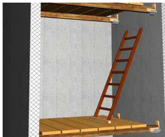
13 Sulle scale la sicurezza è garantita solo se vengono usate correttamente (angolo di appoggio di 70° circa, assicurate contro lo scivolamento, in perfetto stato).
