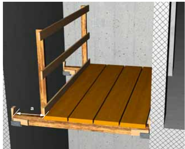
6 Una protezione laterale a 3 elementi impedisce la caduta dall'alto se [a] è superiore a 30 cm.
