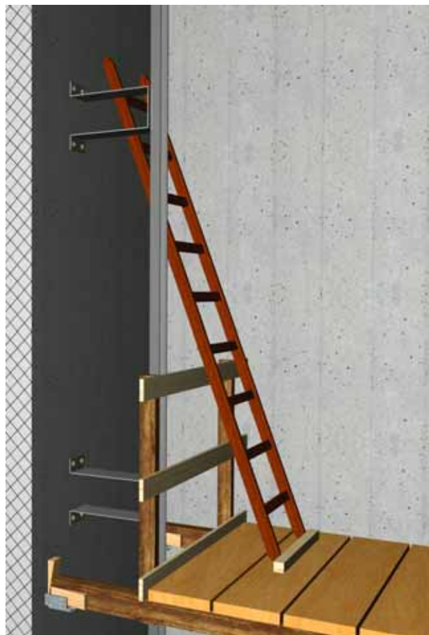
14 Se l'apertura è larga più di 30 cm, esiste un concreto pericolo di caduta. Anche se è presente un parapetto a 3 elementi, per chi lavora sulle scale la migliore protezione è data dall'imbracatura di sicurezza e dalla fune.
