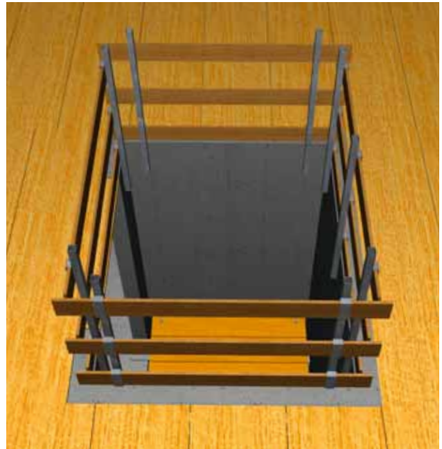
19 Una protezione laterale a 3 elementi impedisce la caduta nel vuoto per chi lavora presso l'ultima soletta.
