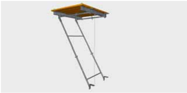
16 Esempio di un ponteggio di ritenuta autobloccante (piattaforma ribaltabile).
