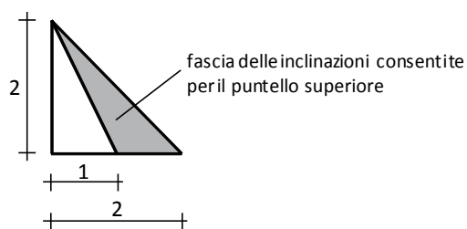
Figura 4.11 Inclinazioni consentite per il puntone superiore.
