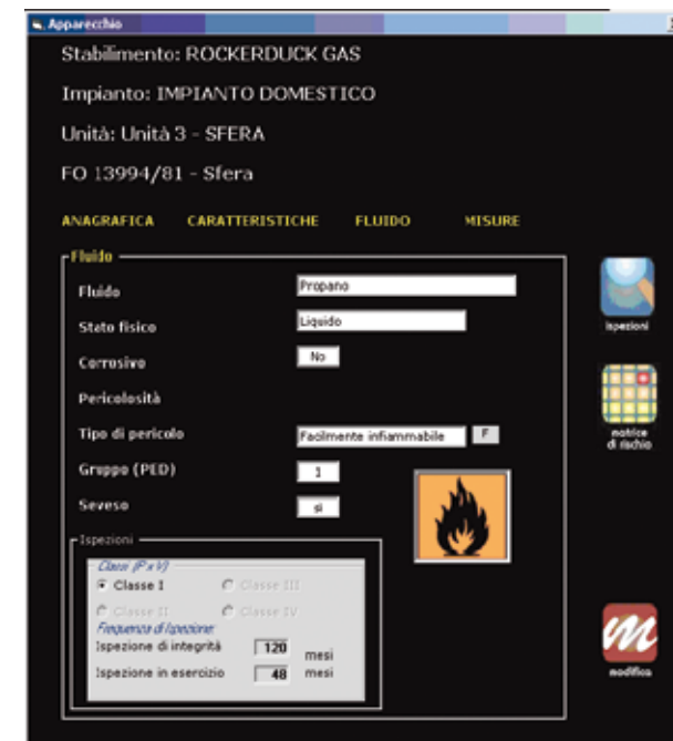
Figura 4.5.2.2.d Frequenze d'ispezione (Verifiche) per un'attrezzatura in pressione, come calcolate da "myInspection"
