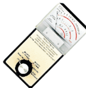
Fig. 48: Strumento per la rilevazione di radiazioni elettromagnetiche
