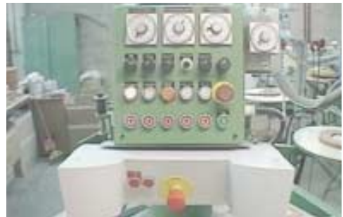
Fig. 32: I comandi di una pulsantiera devono essere ben visibili e di facile comprensione.
