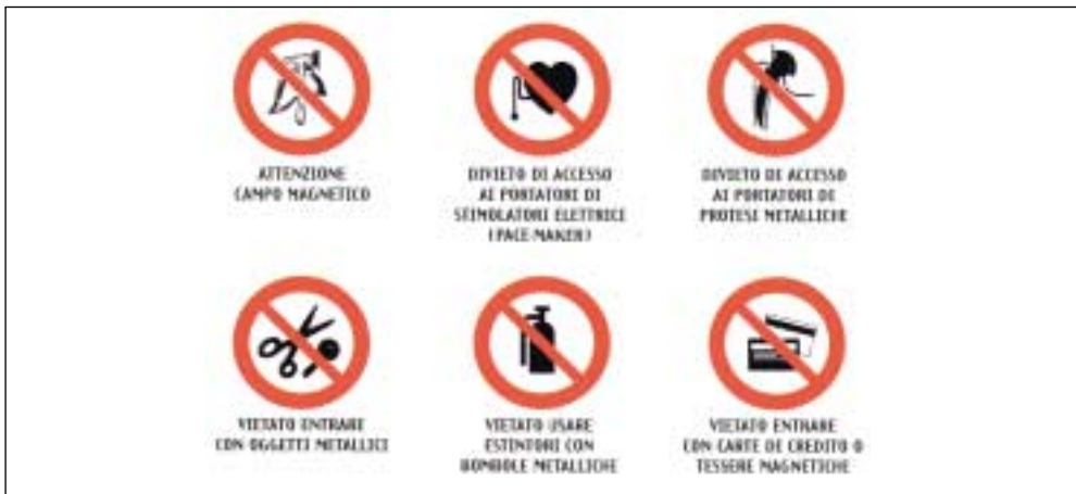
Fig36 Segnaletica CEM- DIVIETO.
